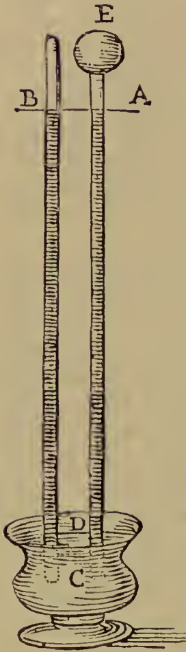
Abb. 57. Torricellis Versuch 2) . Torricelli, Esperienza dell'Argento Vivo.
